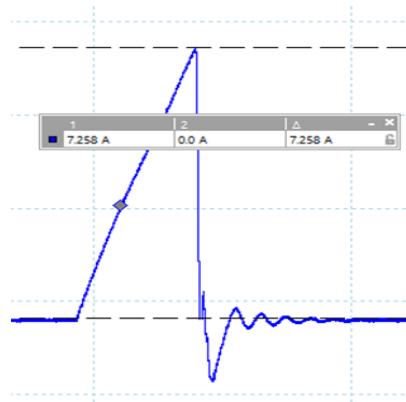
Hình 3.7: Kết quả thực nghiệm cường độ dòng sơ cấp i_1(t)
