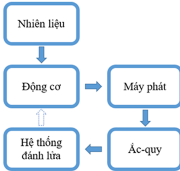
Hình 5.15: Mô tả đường truyền năng lượng từ Nhiên liệu- Hệ thống đánh lửa
